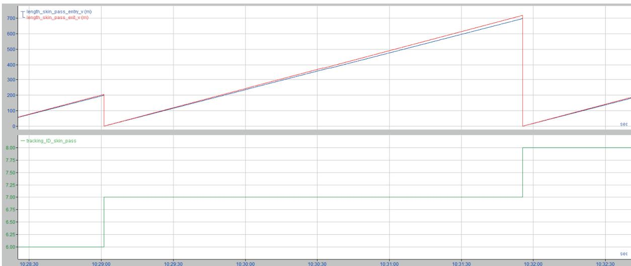
Die Abbildung zeigt oben als Beispiel die Längenmesswerte für Eingangsseite (blau) und Ausgangsseite (rot) an einem Dressiergerüst (ca. 3 % Dressiergrad). Der untere Trend zeigt die Tracking-ID.
